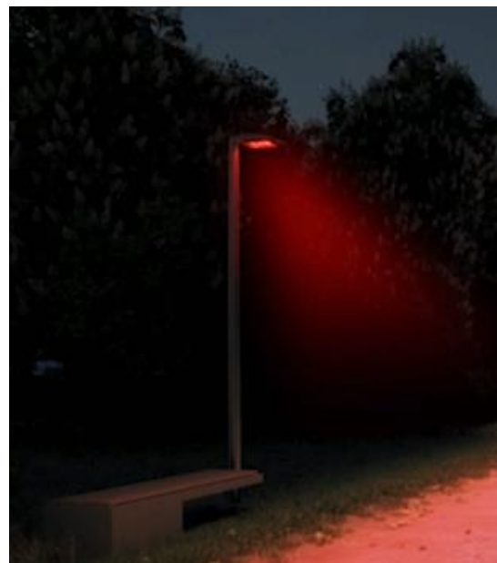
Abb. 2: Biologisches Rotlicht an einem Sommerabend mit einem 30-40% höherem Energieverbrauch gegenüber herkömmlicher Beleuchtung mit ca. 2.700-3.000 Kelvin
